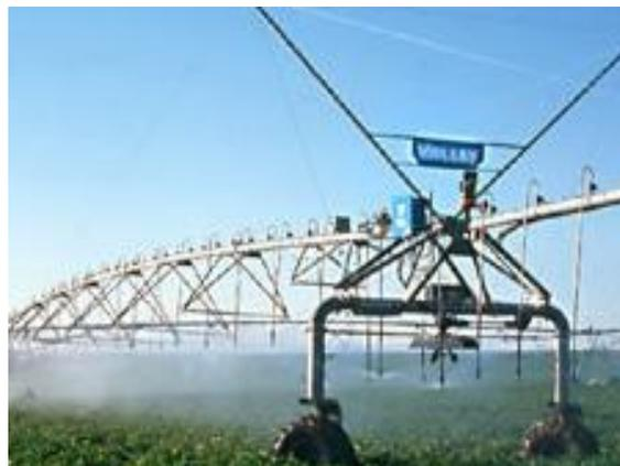
**Рис. 1- Конструкция последней тележки дождевальной машины кругового действия фирмы Valmont Irrigation (США)**
