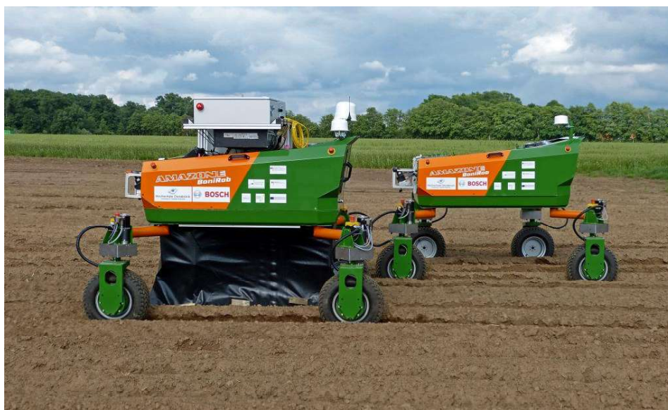
Рис. 2. Полевой робот Amazone-BoschBoniRob
