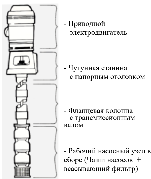
Рисунок 1 - Устройство насоса типа ВНТВ
