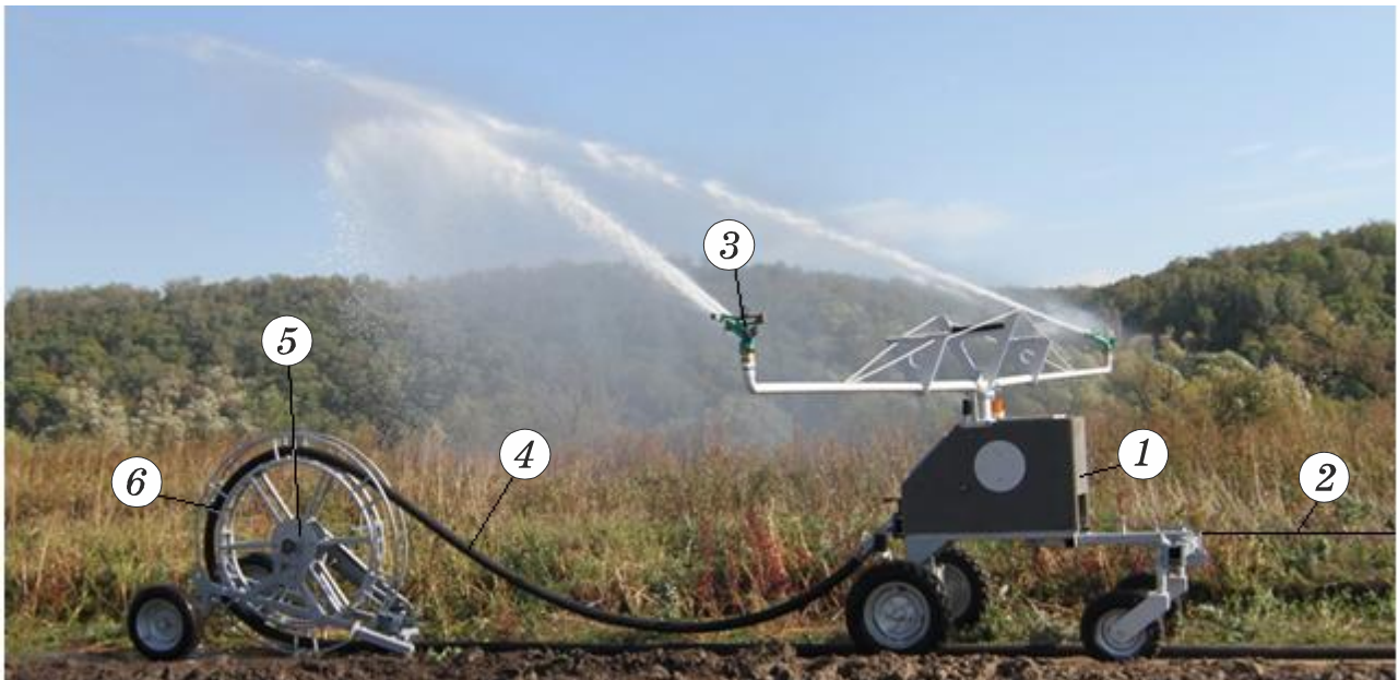
Рис. 3. Экспериментальный образец шланго-барабанной машины ПДМ-00.000: 1 – энергетическая тележка; 2 – тяговый трос; 3 – дождеобразующее устройство; 4 – плосковорачиваемый напорный шланг; 5 – петлеобразователь; 6 – формируемая петля плосковорачиваемого шланга
