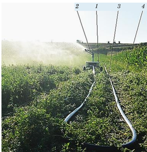
Рис. 1. Перемещение по полю образующей петли плосковорачиваемого шланго-барабанных дождевальных машин второго типа: 1 – энергетическая тележка; 2 – дождевальная аппаратура; 3 – напорный плосковорачиваемый шланг; 4 – перемещаемая петля шланга
