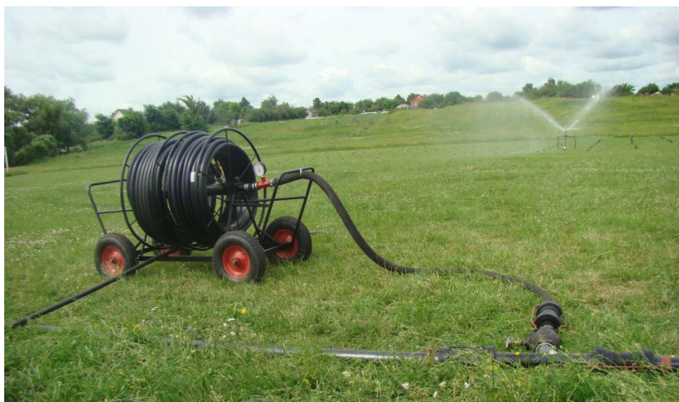
Рисунок 2 – Работа на позиции ШБДМ с двумя барабанами и ручным приводом (ВНИИ «Радуга»)
